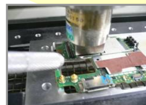
<基板からのIC取り外し作業>
