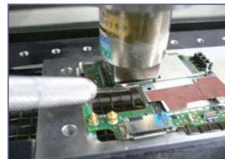
<基板からのIC取り外し作業>
